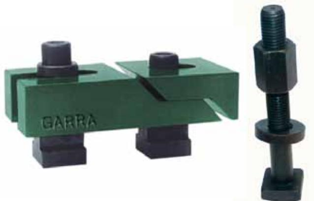
Garra utilizada em fresadoras ou plainas. Utilizadas para usinagem de peças baixas, fixando as mesmas pelas laterais. São fornecidas em três tamanhos: podem ser fixadas com porca "T" ou parafuso para ranhura "T" com cabeça quadrada.
