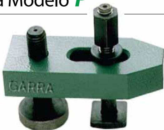
Garras modelo “P” usadas em aço beneficiado altamente resistentes. Utilizadas em injetoras de plásticos, ZAMAK, Alumínio, prensas Excêntricas e outras máquinas operatrizes. São fornecidas com parafusos de regulagem para altura. Utilizam parafusos de cabeça quadrada ou sextavados cabeça alta, todos em aço 1045.
